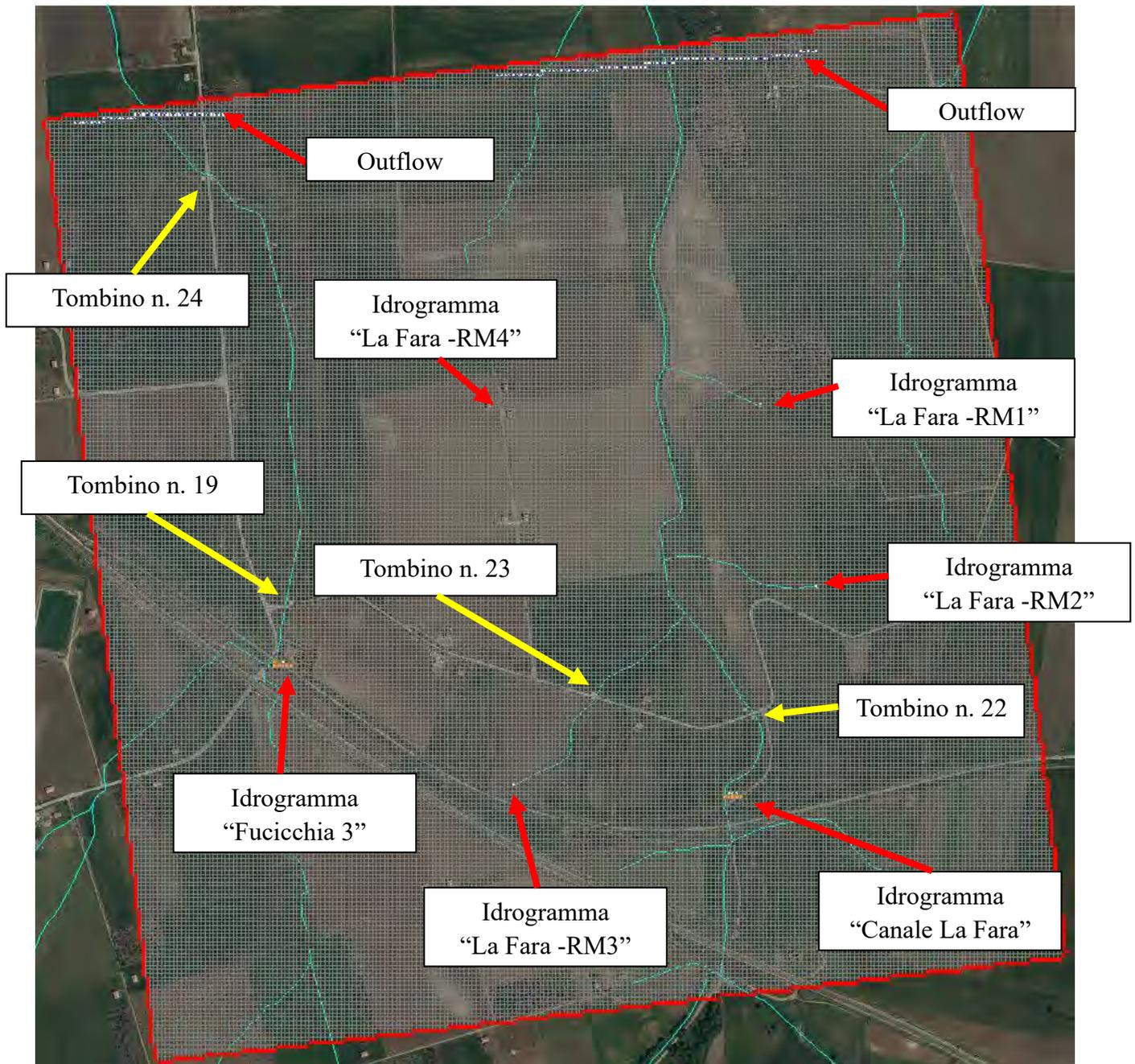
Figura 5.3.1: Dominio di calcolo del modello n.7
