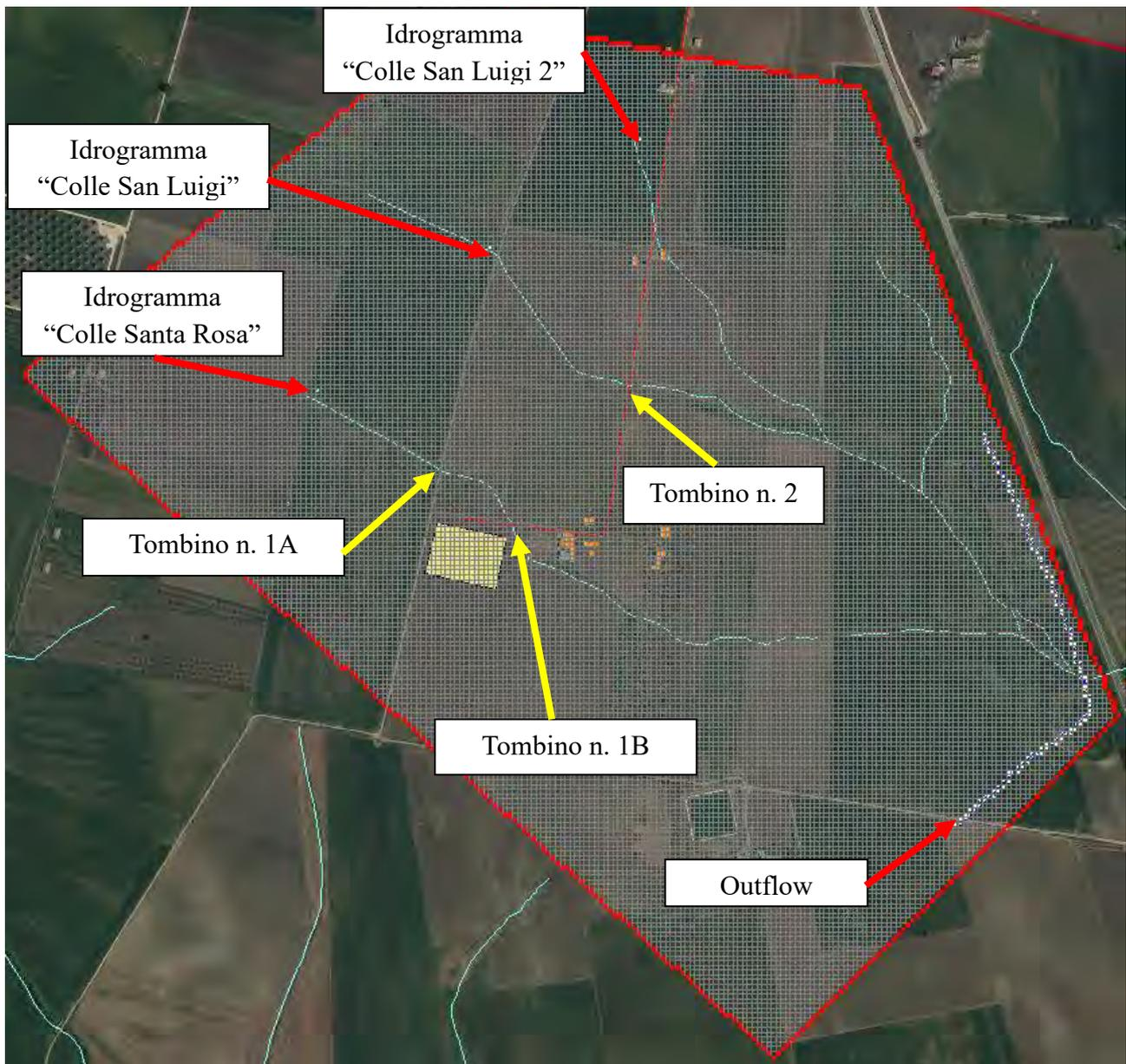
*Figura 5.1.1: Dominio di calcolo del modello n.2*
