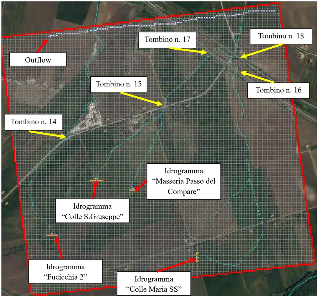
Figura 5.4.1: Dominio di calcolo del modello n.14
