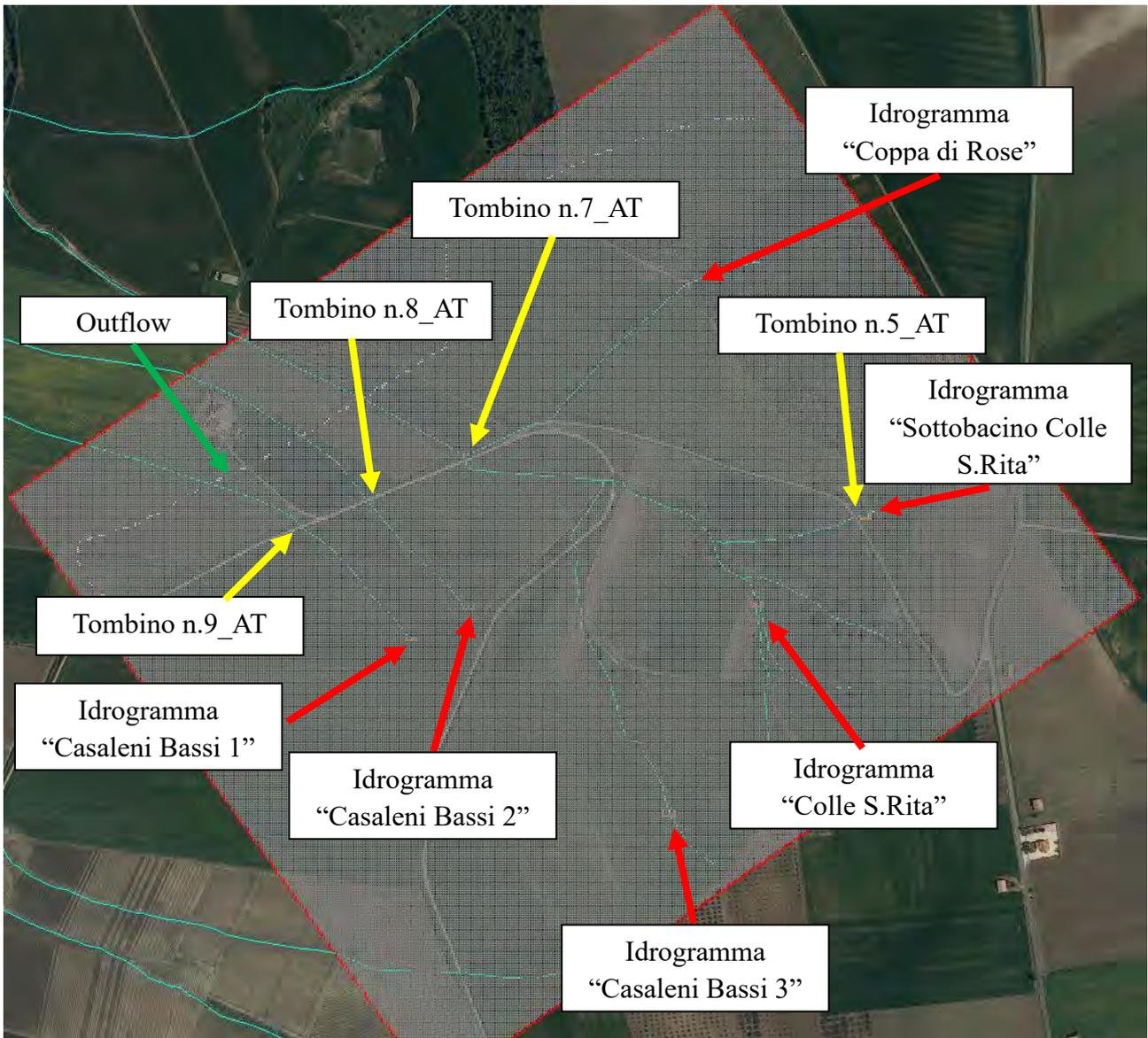
Figura 5.6.1: Dominio di calcolo del modello B
