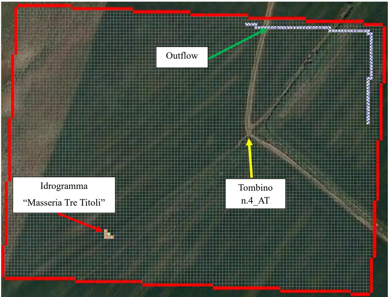
*Figura 5.5.1: Dominio di calcolo del modello A*
