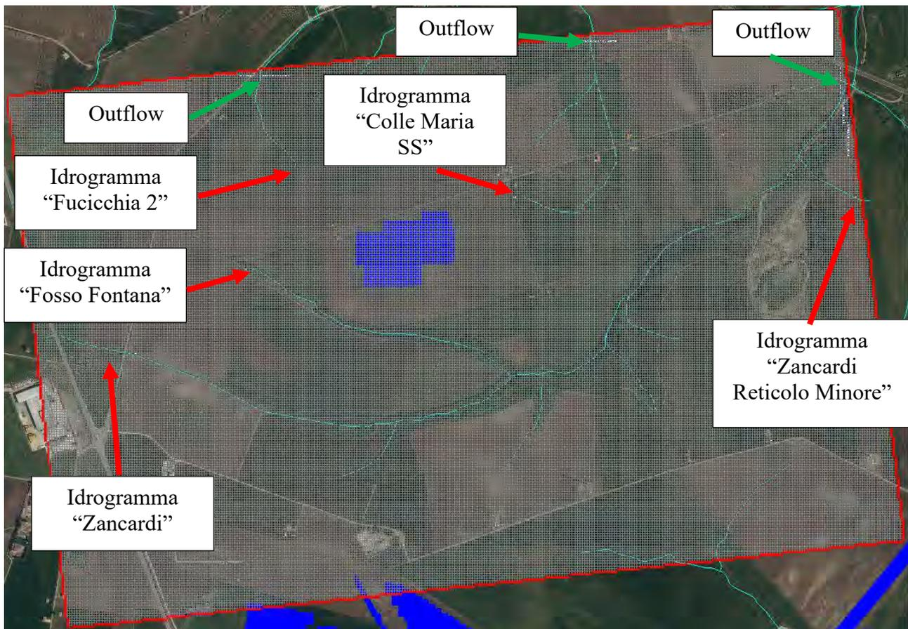
Figura 5.2.1: Dominio di calcolo del modello n.4
