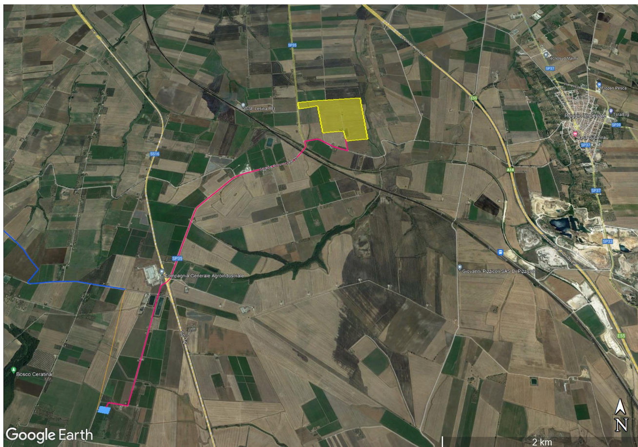
Figura 1: Ortofoto dell'area di impianto, in rosso e giallo: area di impianto; in rosa: percorso del cavidotto dall'area di impianto al condominio; in blu: il condominio; in arancione: tratto aereo del cavidotto; in verde: tratto del cavidotto dal condominio alla SE di smistamento "Serracapirola 2".
