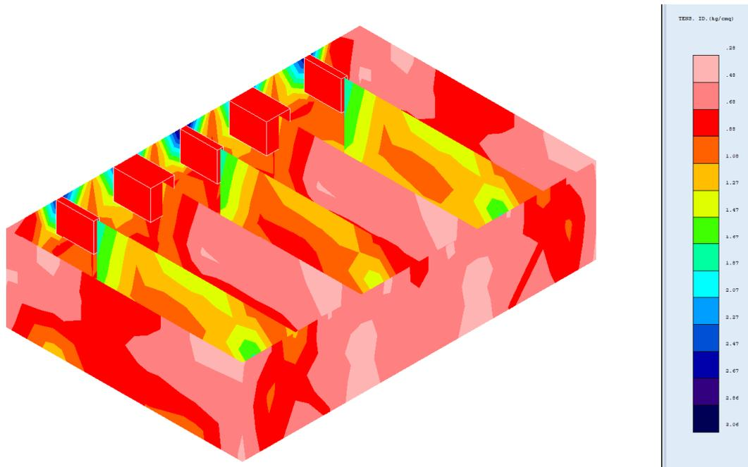
FIG. 15: Stato Tensionale Ideale
