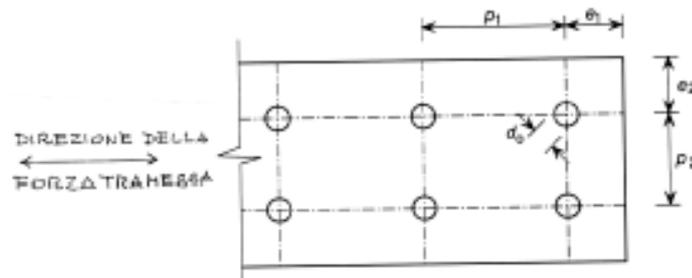
Figura C4.2.34 – Parametri significativi per i collegamenti
