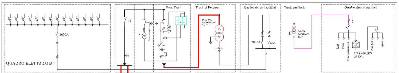
Risulta che la sorgente di campo magnetico sia rappresentata dal trasformatore BT/MT impiegato per innalzare la tensione dal livello di generazione al livello 30 kV, tensione di esercizio della distribuzione elettrica delle linee interrate, e dal trasformatore dei servizi ausiliari di potenza 30kVA.
