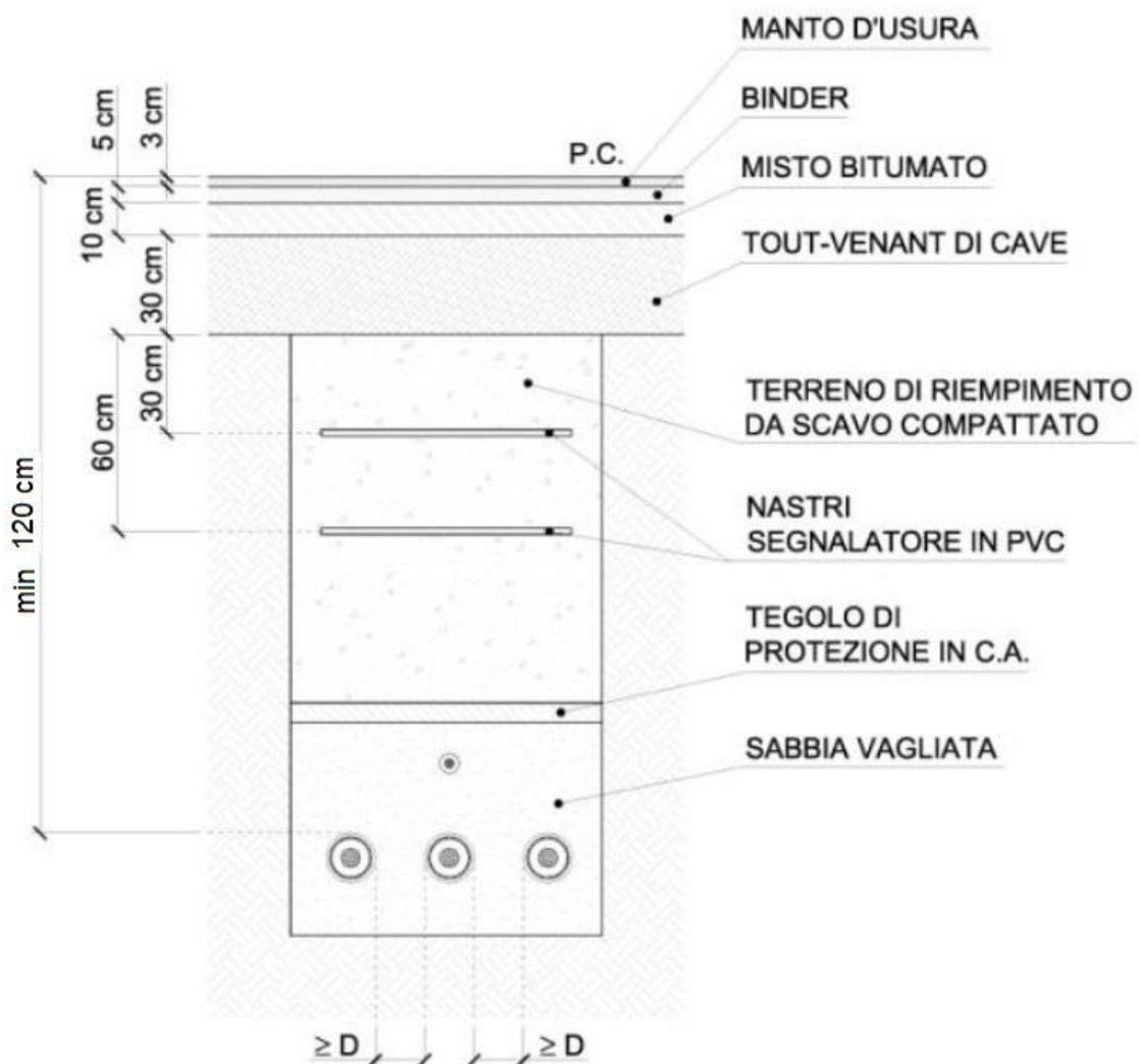
Figura 2. Sezioni tipiche della terna di cavi e condizioni di posa per il cavo da  $1600 \text{ mm}^2$
