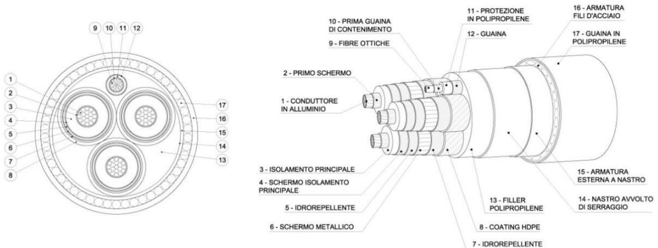
Figura 3. Sezione tipica dei cavi tripolari previsti
