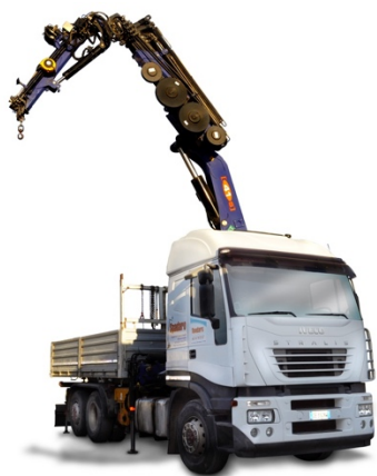
Autogru per sollevamento strutture prefabbricate
