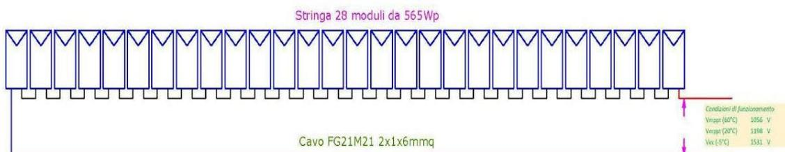
Fig. 16. Particolare serie moduli fotovoltaici.
