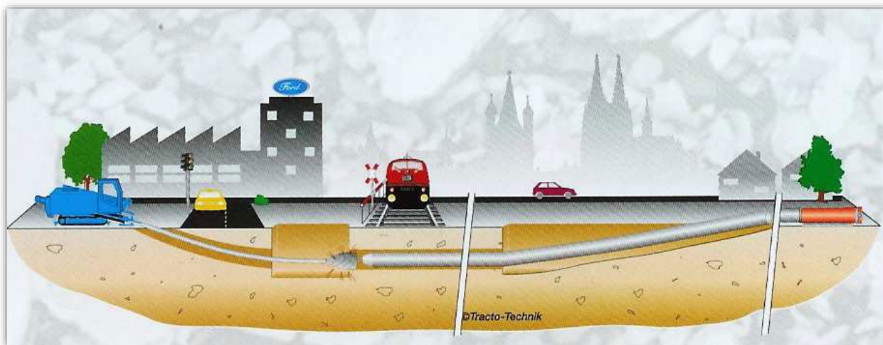
Figura 9 - Schema di principio dell'attraversamento in T.O.C.
