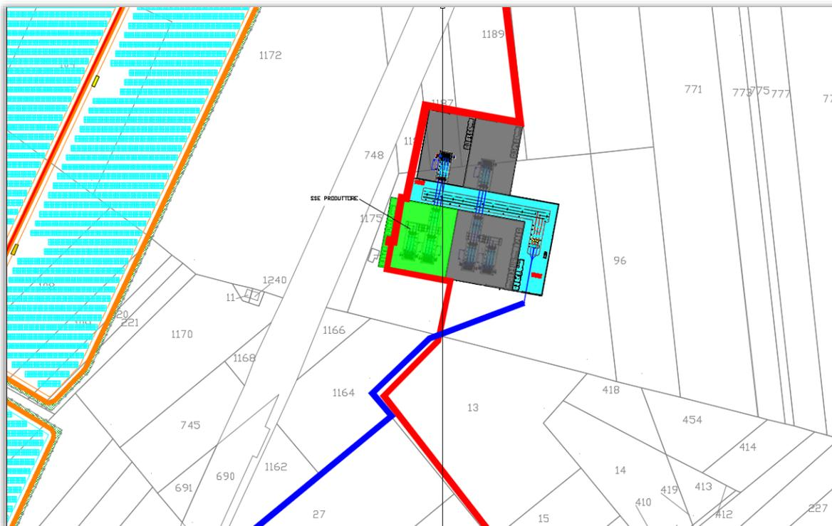
Figura 1a - Planimetria Sottostazione elettrica condivisa su CTR: in verde lo stallo assegnato all'impianto in esame; in grigio, gli stalli assegnati alle società produttori condidenti; in ciano, il sistema di sbarre comuni a 150 kV; in blu, l'elettrodotto interrato AT per la connessione in SE-RTN; in rosso, i cavidotti in MT per le connessioni interne dell'impianto in esame.
