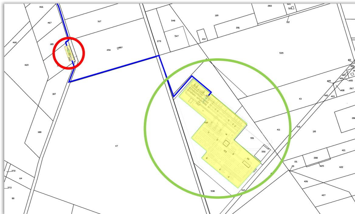
Figura 2 - - Planimetria Stazione Elettrica "San Severo" e SdS su CTR: in blu l'elettrodotto interrato AT per la connessione alla SE-RTN; in verde lo stallo assegnato da TERNA per il collegamento in antenna 150kV. Cerchiato: in rosso, stallo di sezionamento AT; in verde, SE-RTN "San Severo"
