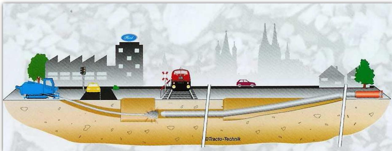
Figura 7 - Schema di principio dell'attraversamento in T.O.C.
