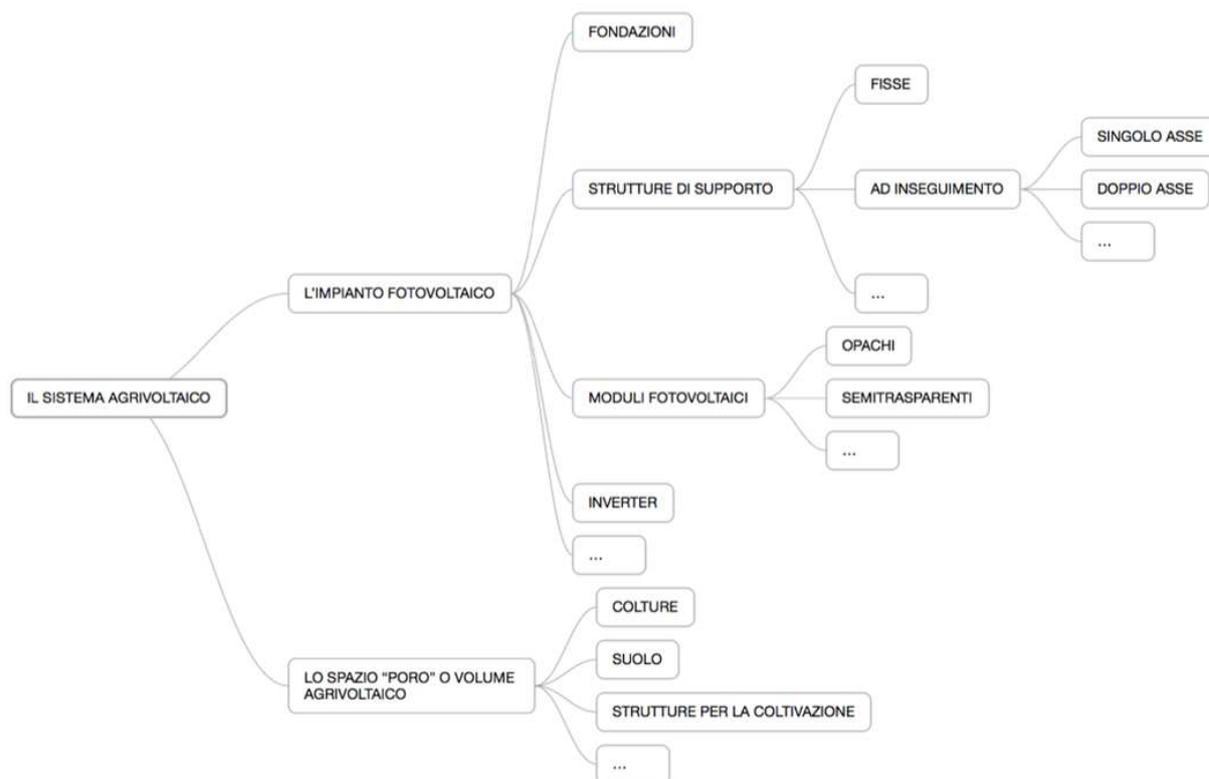
Figura 7. Le varie parti che compongono il "Sistema agrivoltaico" e che quindi concorrono alla composizione della  $S_{tot}$ . Tratto dalle Linee guida.
