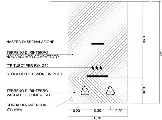
**PARTICOLARI COSTRUTTIVI CAVIDOTTO BT INTERNO**
