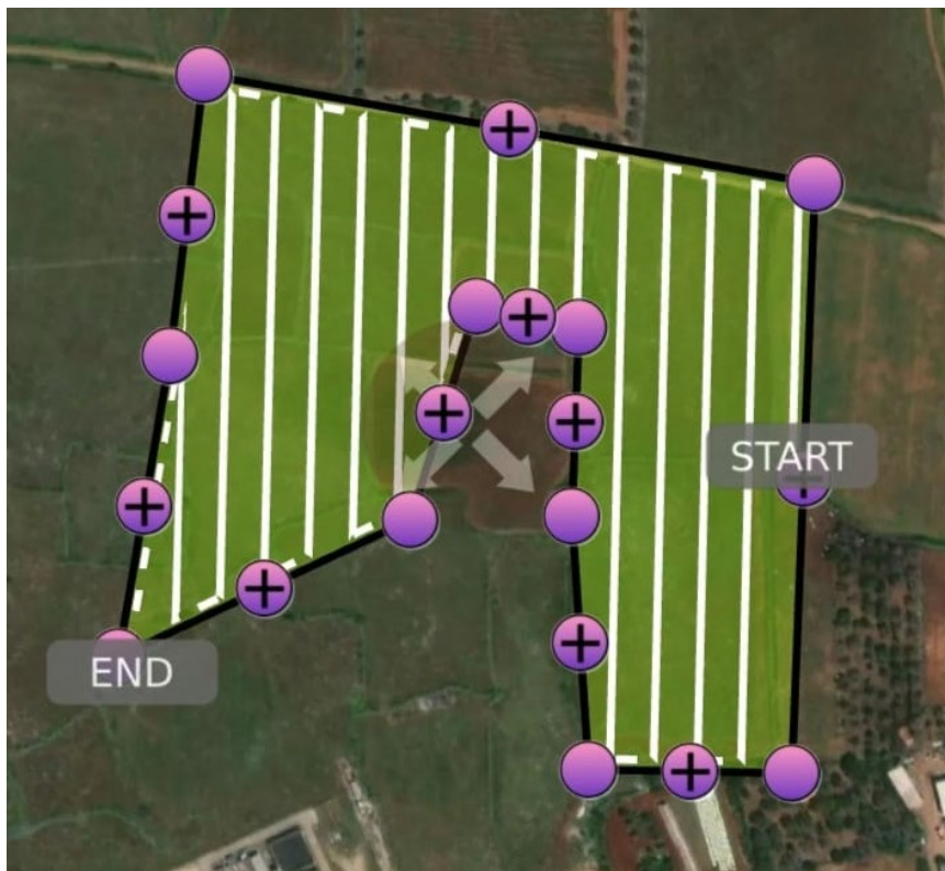
Figura 4 Pianificazione missione con Pix4D
