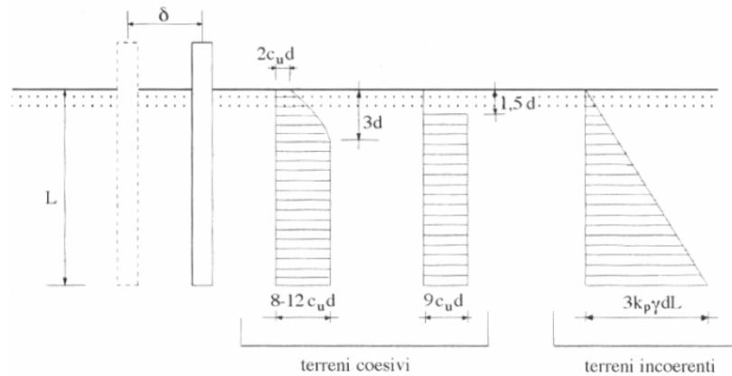
**Figura 16 - Resistenza limite del terreno**
