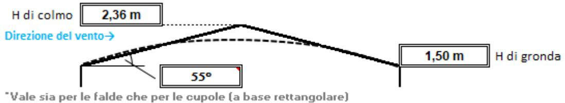
**Figura 8 - Schema copertura inclinata per il calcolo dell'azione del vento**
