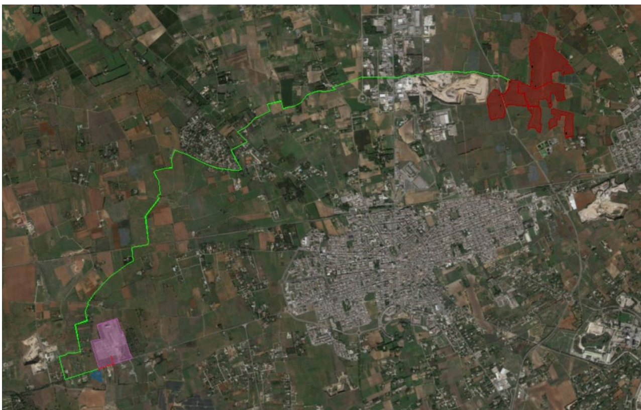
Figura 36 - Area impianto FV in rosso, SSU in azzurro e stazione RTN in magenta
