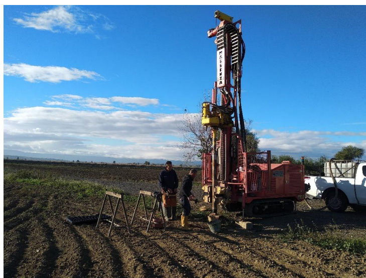
Figura 2-3: Sonda oleodinamica Massenza MI4
