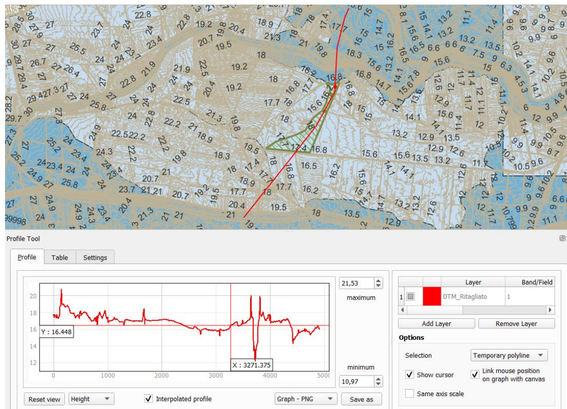
Figura 5.3: Profilo altimetrico e planimetria con aree allagabili (PAI) – area di alta in blu e area di media in azzurro
