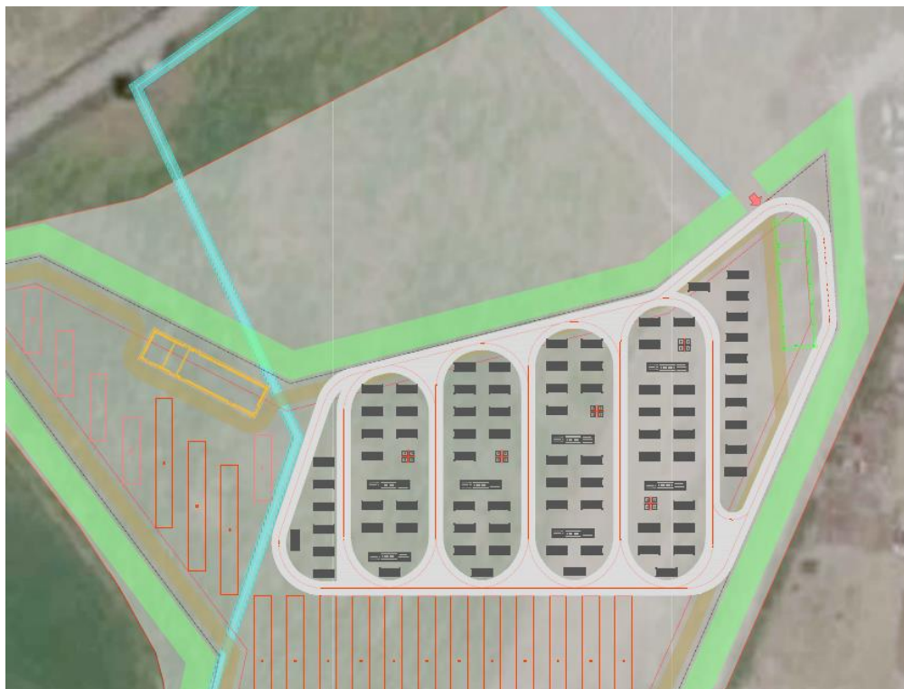
Figura 4.1: Layout impianto BESS
