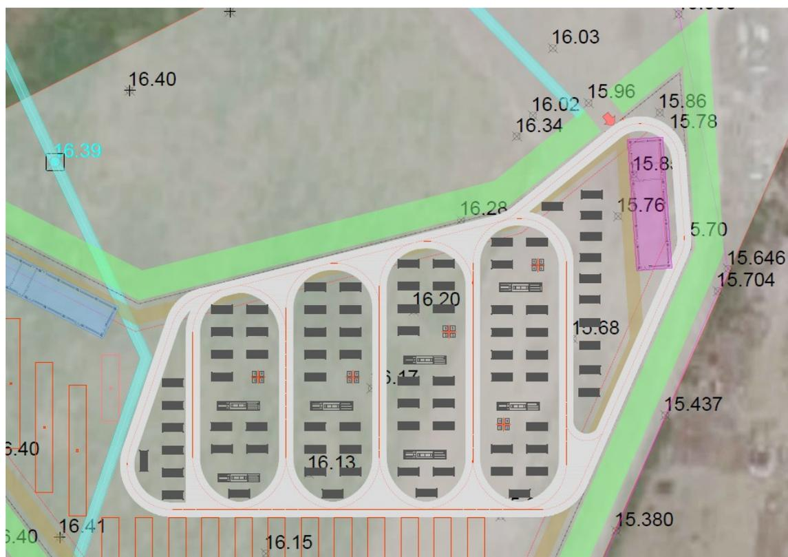
Figura 5.6: Layout di progetto del sistema BESS
