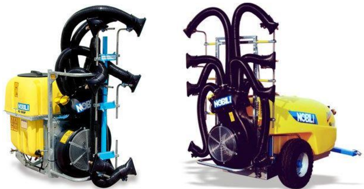
Figura 11-5 – Esempi di turboatomizzatore portato e trainato con getti orientabili per trattamenti su uno o entrambi i lati del frutteto (Foto: Nobili S.r.l.)
