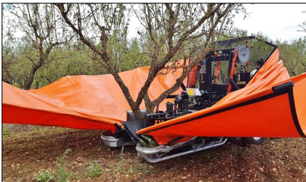
Figura 10-7 – Macchina frontale per la raccolta delle olive/mandorle su intensivo (Foto: Dott. Agr. Vito Vitelli)
