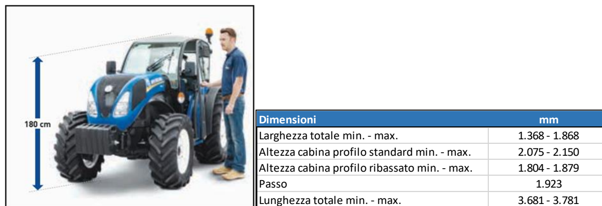
Figura 11-1 – Dimensioni caratteristiche di un trattore da frutteto con cabina ribassata (Fonte: CNH)
