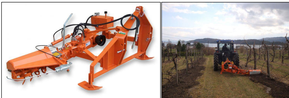
Figura 9-3 – Esempio di fresatrice interceppo per le lavorazioni sulla fila (Foto: Rinieri S.r.l.)
