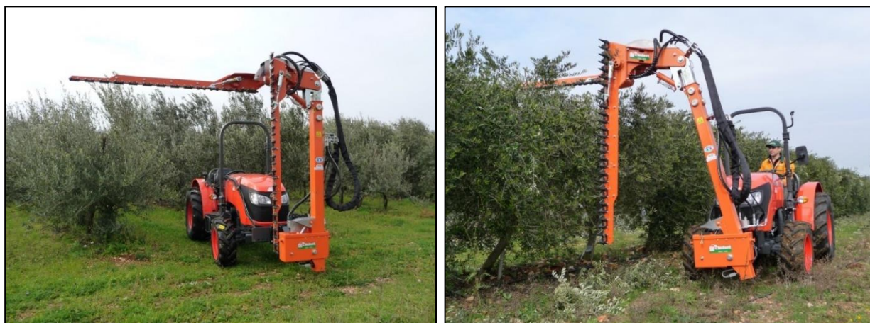
Figura 11-3 – Esempio di potatrice meccanica frontale a doppia barra (taglio verticale + topping) utilizzabile su tutti le colture arboree intensive e superintensive (Foto: Rinieri S.r.l.)
