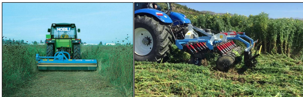
Figura 10-3 – Trinciatura del manto erboso, utilizzando la trincia o direttamente con il frangizolle a dischi. (Foto: Nobili S.r.l. / Siciltiller S.r.l.)
