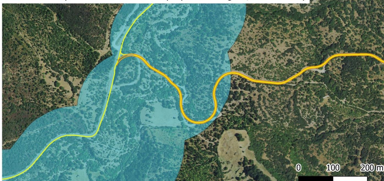
Figura 1.3 - Sovrapposizione con fascia di 150 metri di tutela paesaggistica (Art. 142 comma 1 lettera c) in corrispondenza di alcuni tratti di viabilità in progetto
