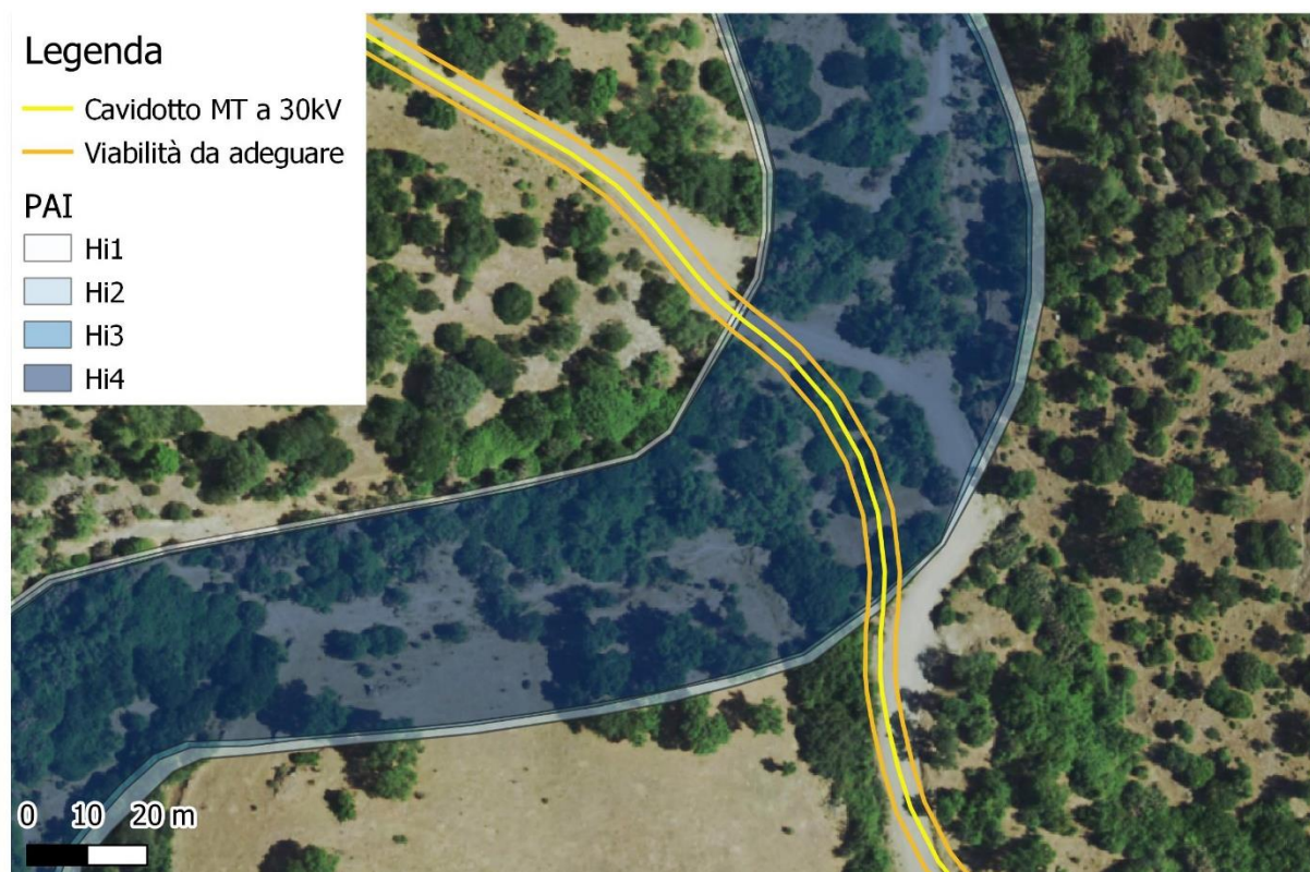
Figura 1.12: Sovrapposizione delle opere in progetto con aree cartografate a pericolosità idraulica dalle NTA del PAI
