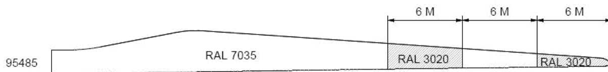
Figura 4 – Schema indicativo colorazione pale (la larghezza effettiva delle bande colorate sarà apposta in accordo con quanto specificato in Tabella 6.2)
