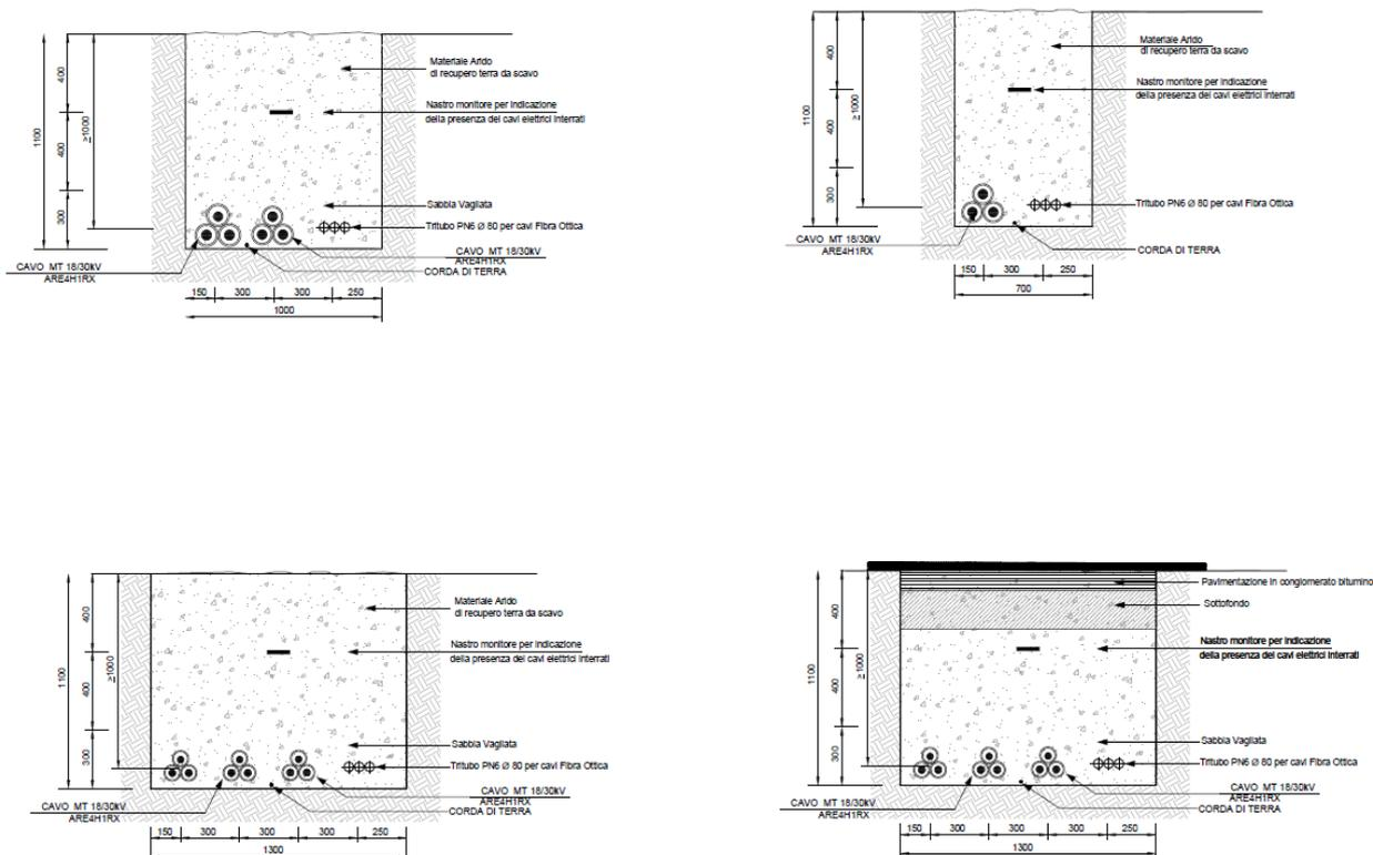
Figura 3.3 – Tipico modalità di posa Cavo a 30 kV
