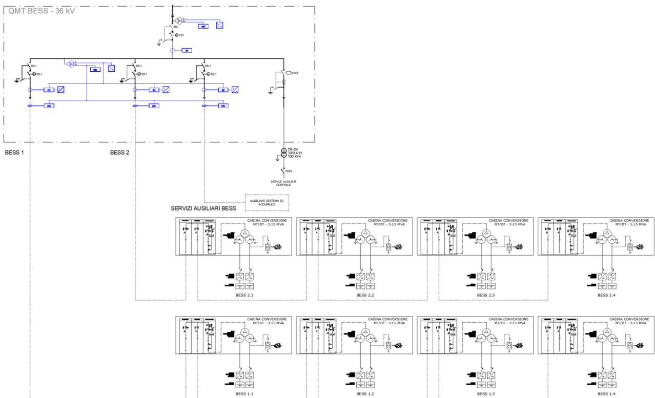
Figura 2.5 – Schema Unifilare Impianto Eolico “Energia Monte Taccu” - Parte BESS
