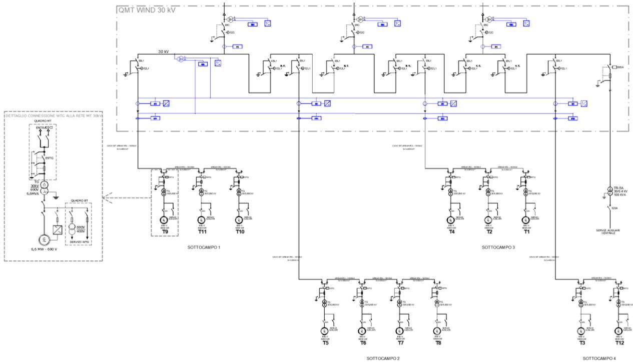
Figura 2.4 – Schema Unifilare Impianto Eolico “Energia Monte Taccu” – Parte Parco eolico
