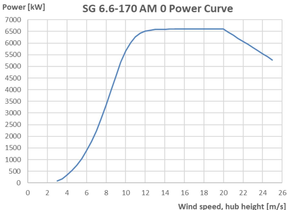
Figura 2.3 – Dati curva di potenza generatore tipo SG 6.6-170
