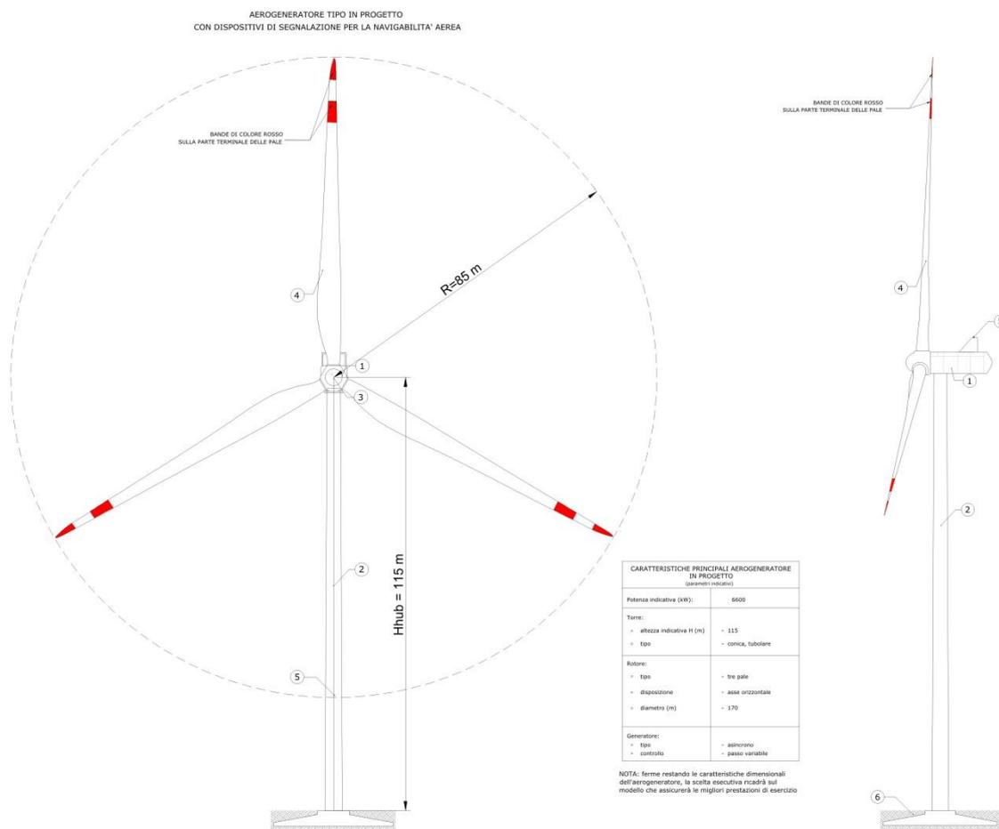
Figura 2.2 – Aerogeneratore tipo Siemens-Gamesa tipo SG 6.6-170 altezza al mozzo (1) 115 m, e diametro rotore (4) di 170 m
