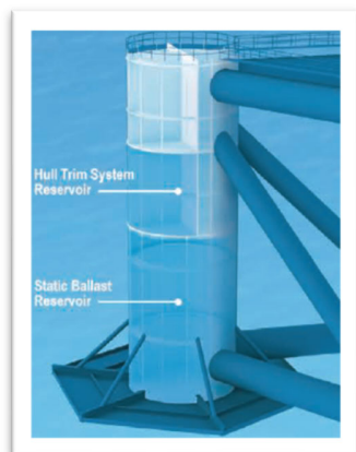
Figura 4.4 Sistemi di zavorramento
