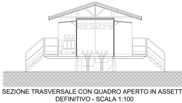
SEZIONE TRASVERSALE CON QUADRO APERTO IN ASSETTO DEFINITIVO - SCALA 1:100
