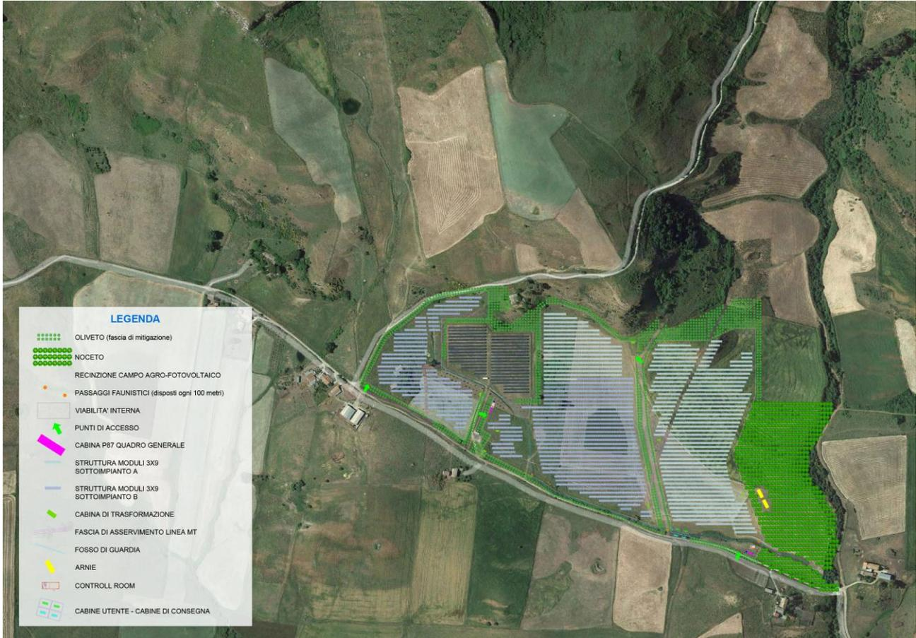
Figura 8 – Layout impianto agro-fotovoltaico
