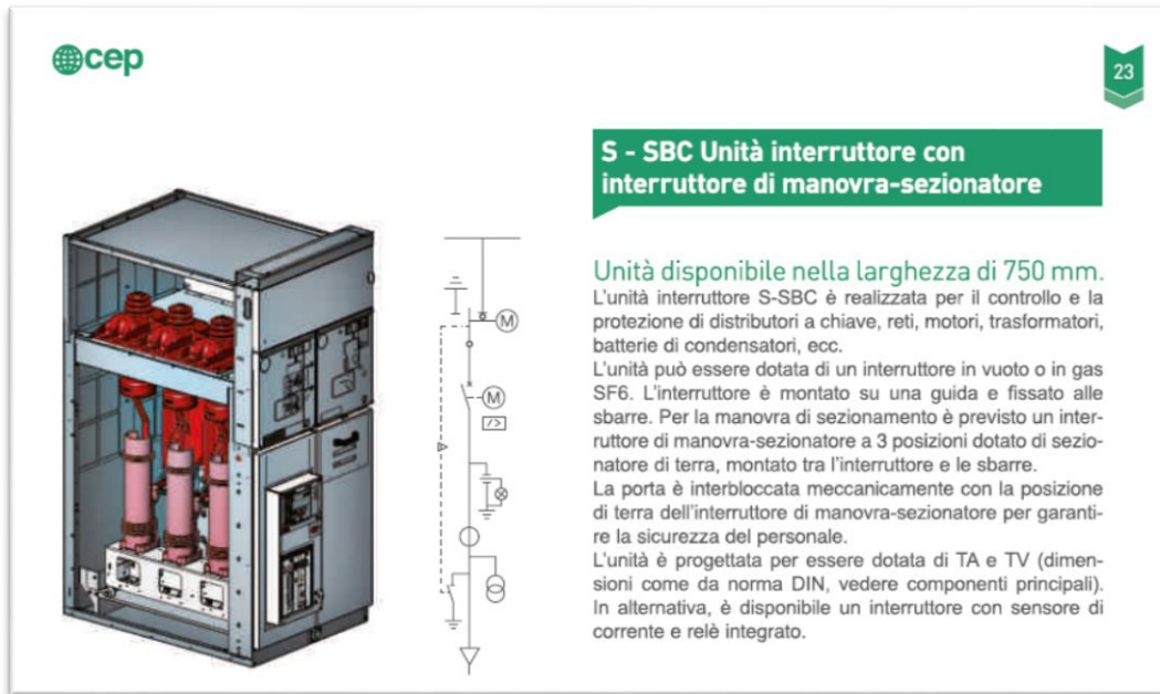
Figura 27: scomparto partenza linea verso il campo FV
