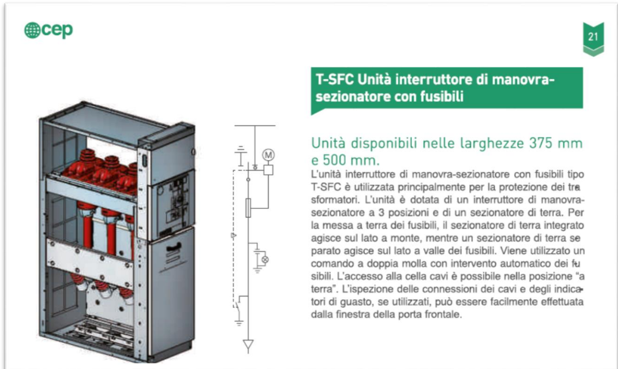
Figura 28: scomparto protezione trasformatore servizi ausiliari
