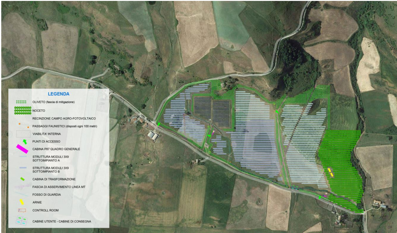
Figura 6 – Layout impianto agro-fotovoltaico
