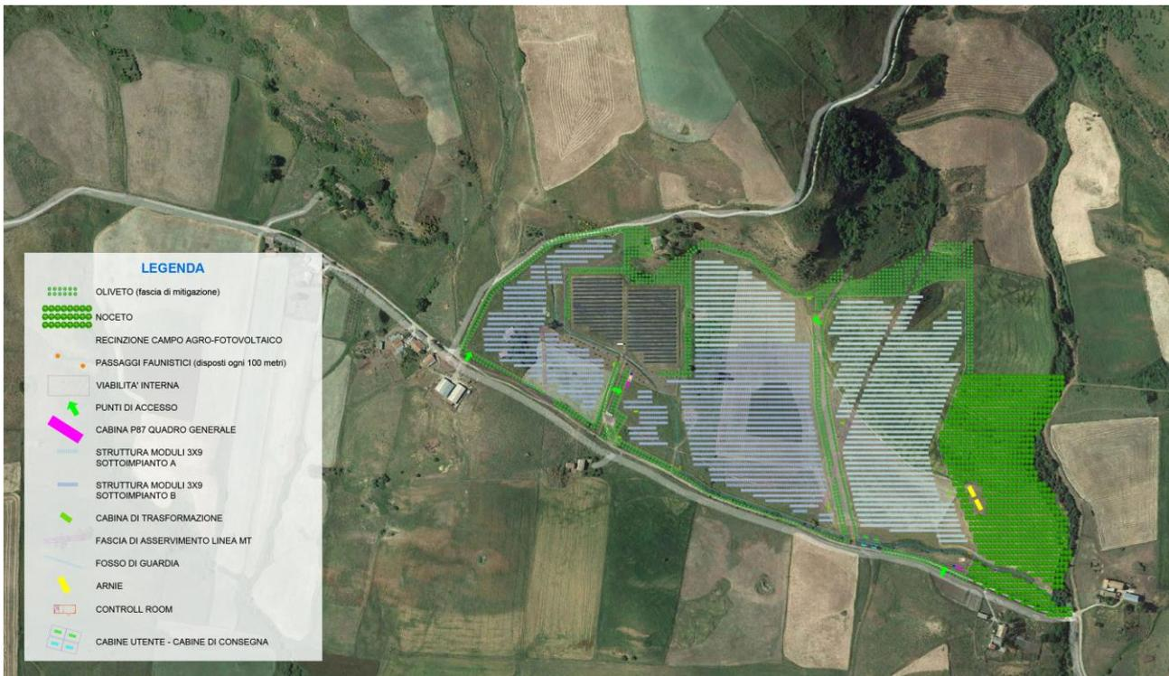
Figura 2 – Layout impianto agro-fotovoltaico
