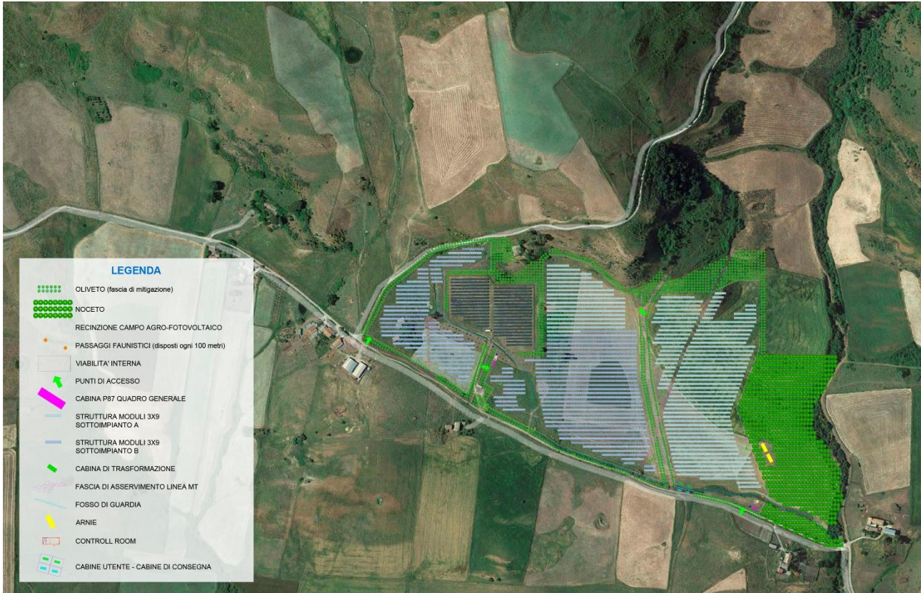
Figura 6 – Layout impianto agro-fotovoltaico
