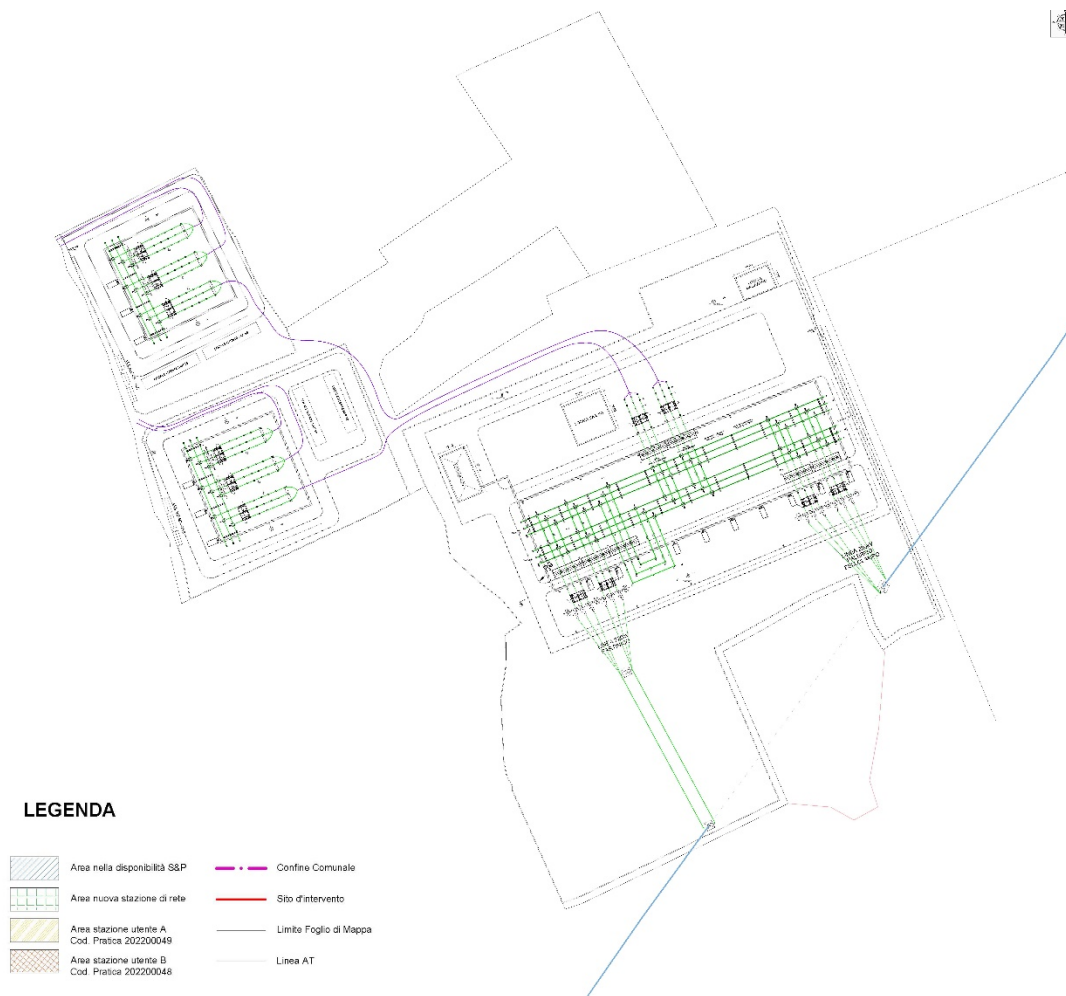
Figura 4 – Pianta elettromeccanica generale – Stazione utente
