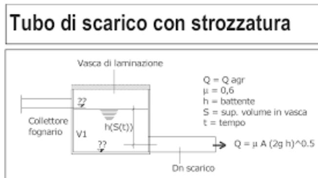
Considerando che ciascuna vasca di laminazione prevista avrà dimensioni 20 m X 5 m ed una altezza di 1 m ed una capacità di 100 m<sup>3</sup>, adottando un battente di 0,7 m e un tubazione in PVC DN160 per la strozzatura in uscita dalle vasche di laminazione, si ottiene una portata massima di 40,35 l/s, inferiore a quella massima ammissibile pari a 61 l/s all'uscita di ogni vasca.
