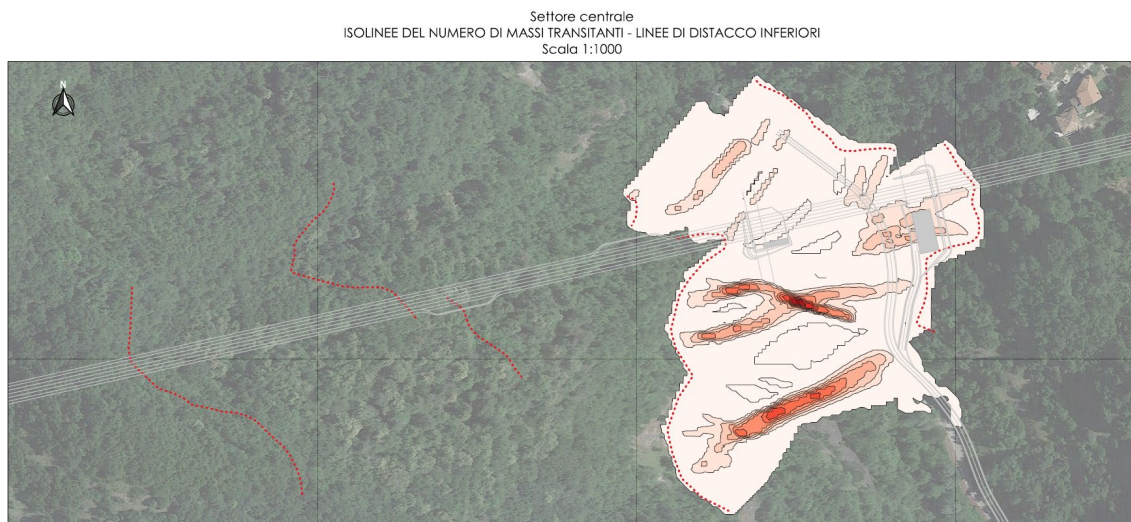
Figura 7-3: Stralcio dell'analisi traiettografica che mostra l'interferenza con le opere in progetto
