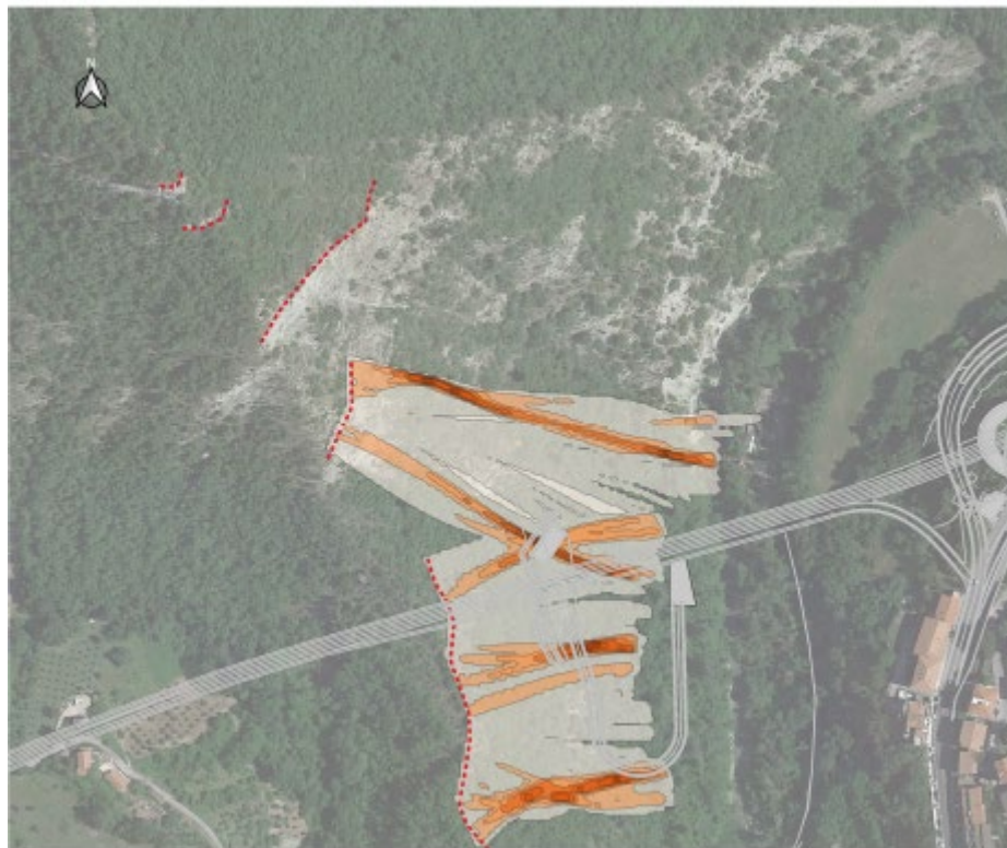
Figura 5 - Stralcio delle sorgenti (linee rosse tratteggiate) e traiettorie di crollo individuate in corrispondenza del dissesto 1475-H2.
