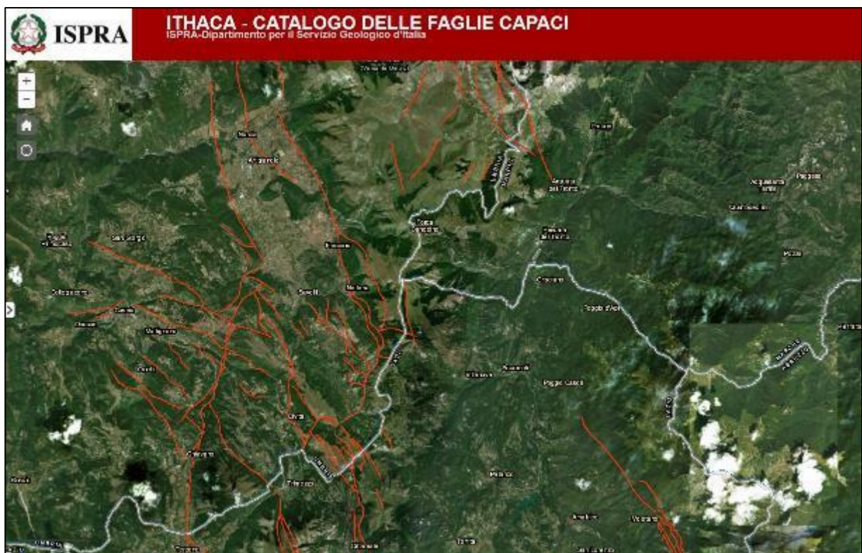
Figura 8-5 - Stralcio cartografico Progetto ITHACA con indicazione delle faglie capaci (fonte ISPRA-SGI). 1: sistema Vettoretto faglie normali (primaria); 2: sistema M.te Vettore-M.te Bove faglie normali-oblique sx (primaria); 3: sistema Forca di Presta faglie normali-oblique sx (primaria); 4: sistema Dogana faglie normali (secondaria); 5: sistema Amatrice faglie normali (primaria); 6: sistema Colle Montellume faglie normali (primaria).
