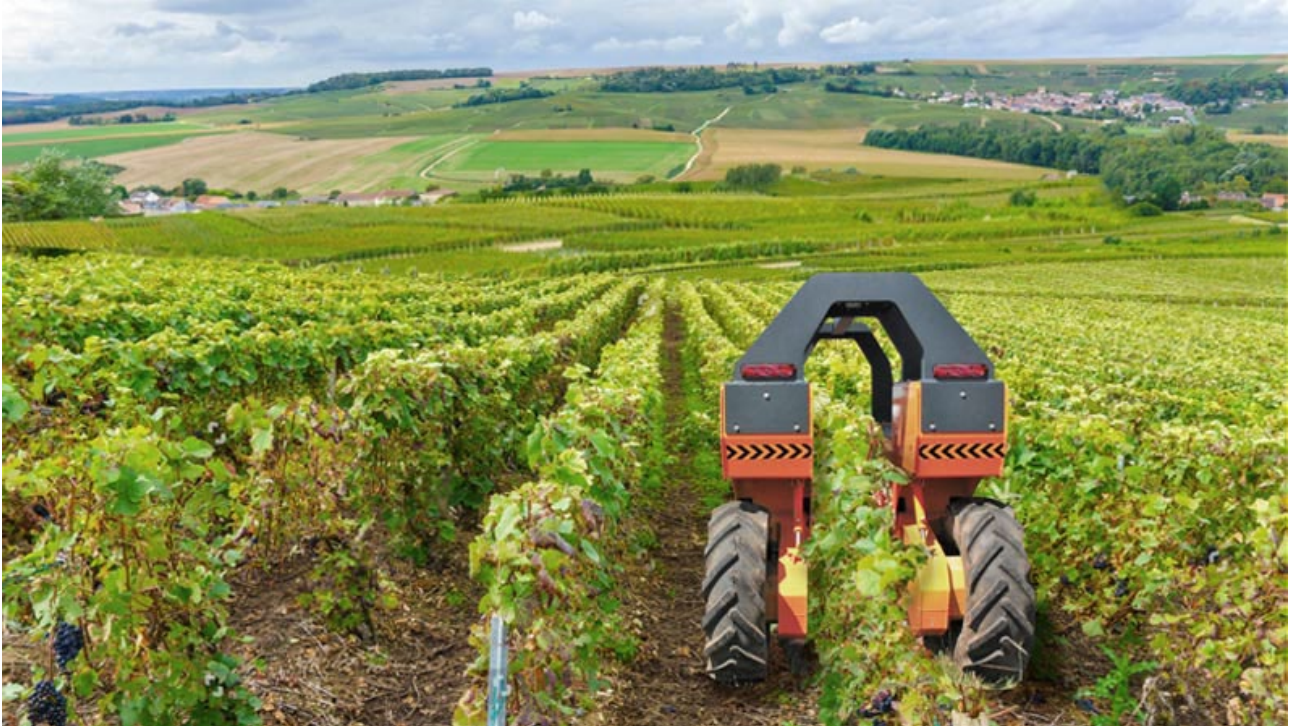
Immagine tratta dalla rivista “flashbattery.tech”-Scavallatrice elettrica robotizzata.
