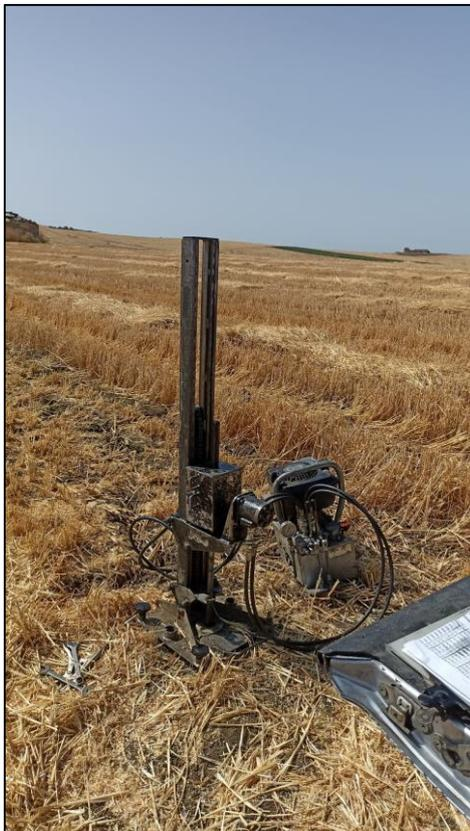
***(Foto n° 8 – Prova penetrometrica Din\_08)***
