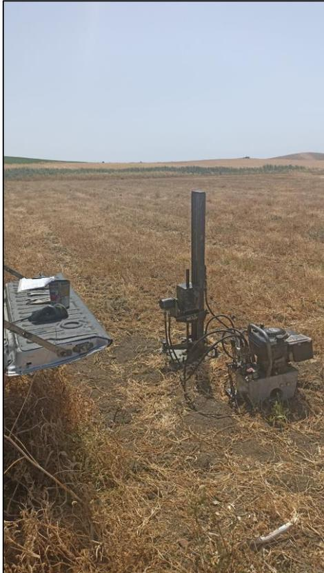
***(Foto n° 6 – Prova penetrometrica Din\_06)***
