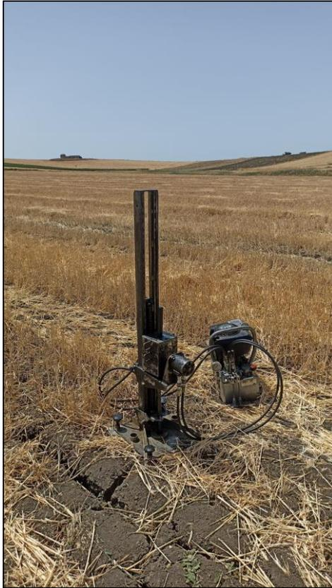
***(Foto n° 3 – Prova penetrometrica Din\_03)***
