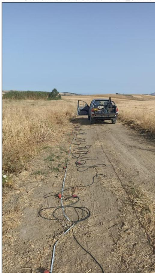
**(Foto n° 2 - Stendimento sismico: Tom\_02-Masw\_02)**
