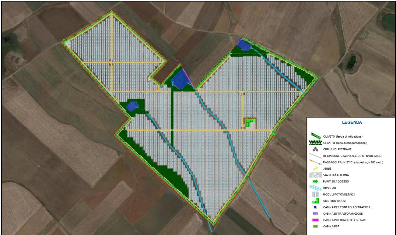
Figura 1 – Layout area impianto agro-fotovoltaico
