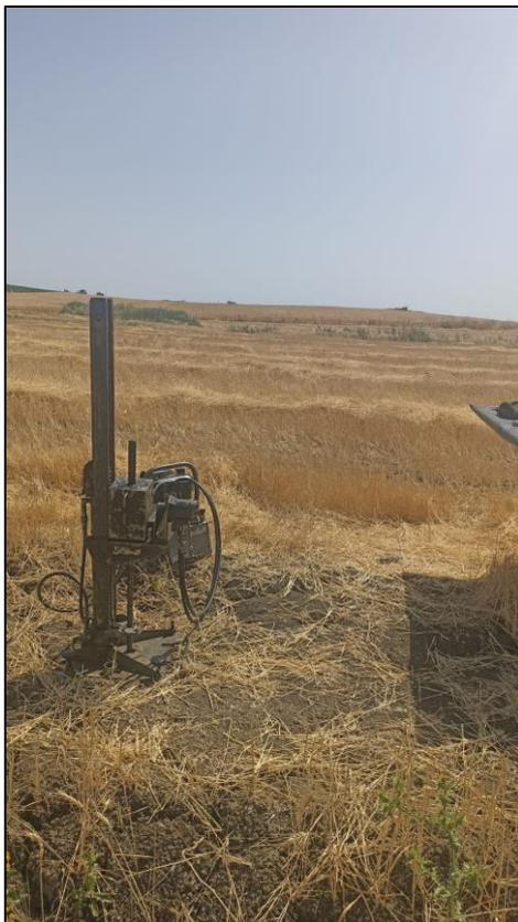
***(Foto n° 4 – Prova penetrometrica Din\_04)***
