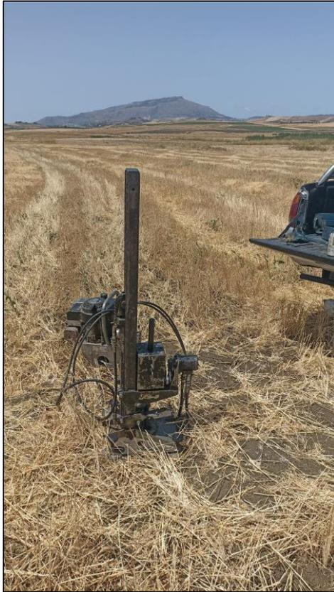
***(Foto n° 5 – Prova penetrometrica Din\_05)***
