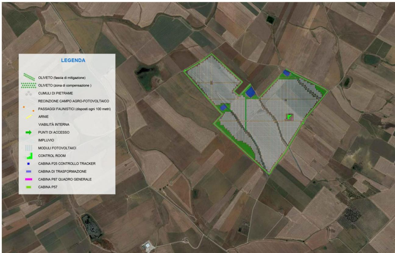
Figura 6 – Layout impianto agro-fotovoltaico
