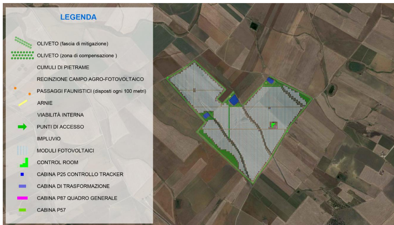
Figura 2 – Layout impianto agro-fotovoltaico
