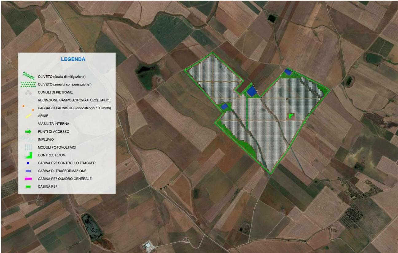
Figura 25 – Layout impianto agro-fotovoltaico
