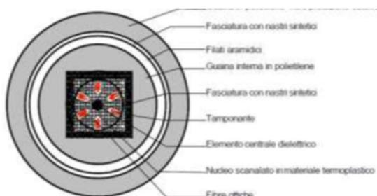
Fig. 1 – Sezione tipica del sistema di telecomunicazioni
