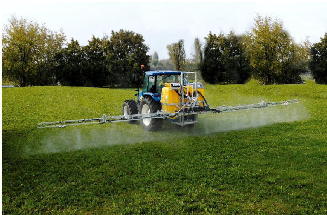
Figura 10: Barra irroratrice con ugelli antideriva
