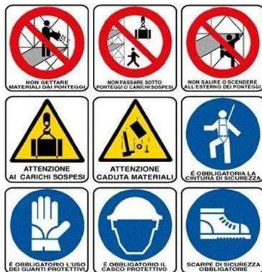
Cartellonistica minima di cantiere
