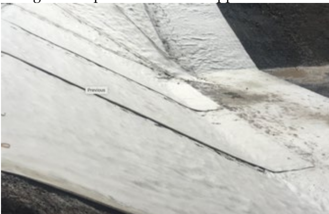
Esempio di "geocomposito bentonitico"
