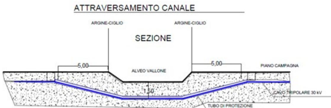
Tavola n. 44: sezione tipo attraversamento canali con tecnica dello "spingi tubo".
