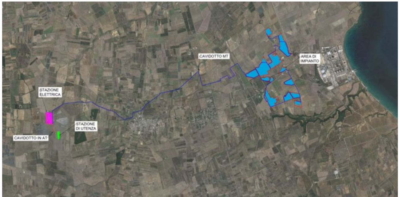
Tavola n. 6: impianto nel suo complesso, con cavidotto e CP
