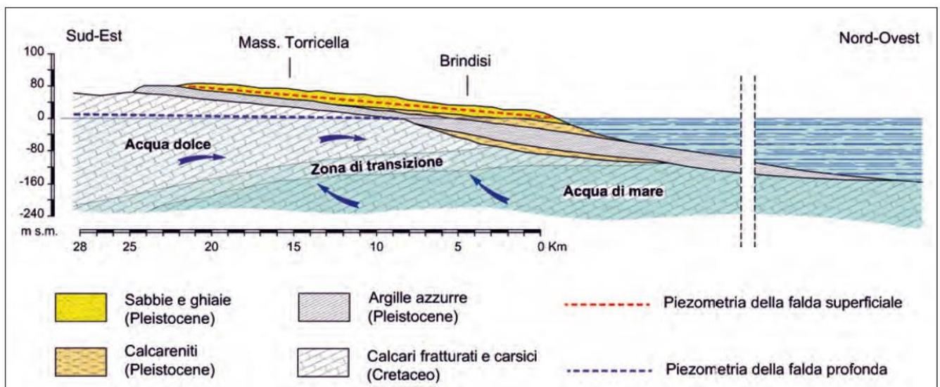
Fig. 11. Sezione idrogeologica schematica della piana di Brindisi perpendicolare al litorale adriatico
