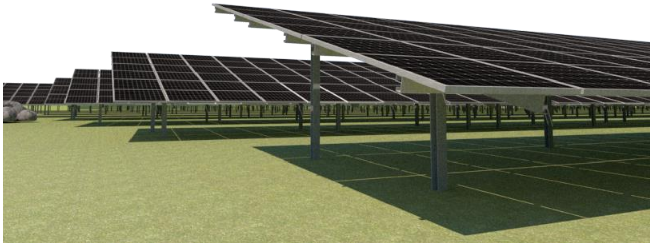
Figura: vista 3D struttura di supporto stringa.
