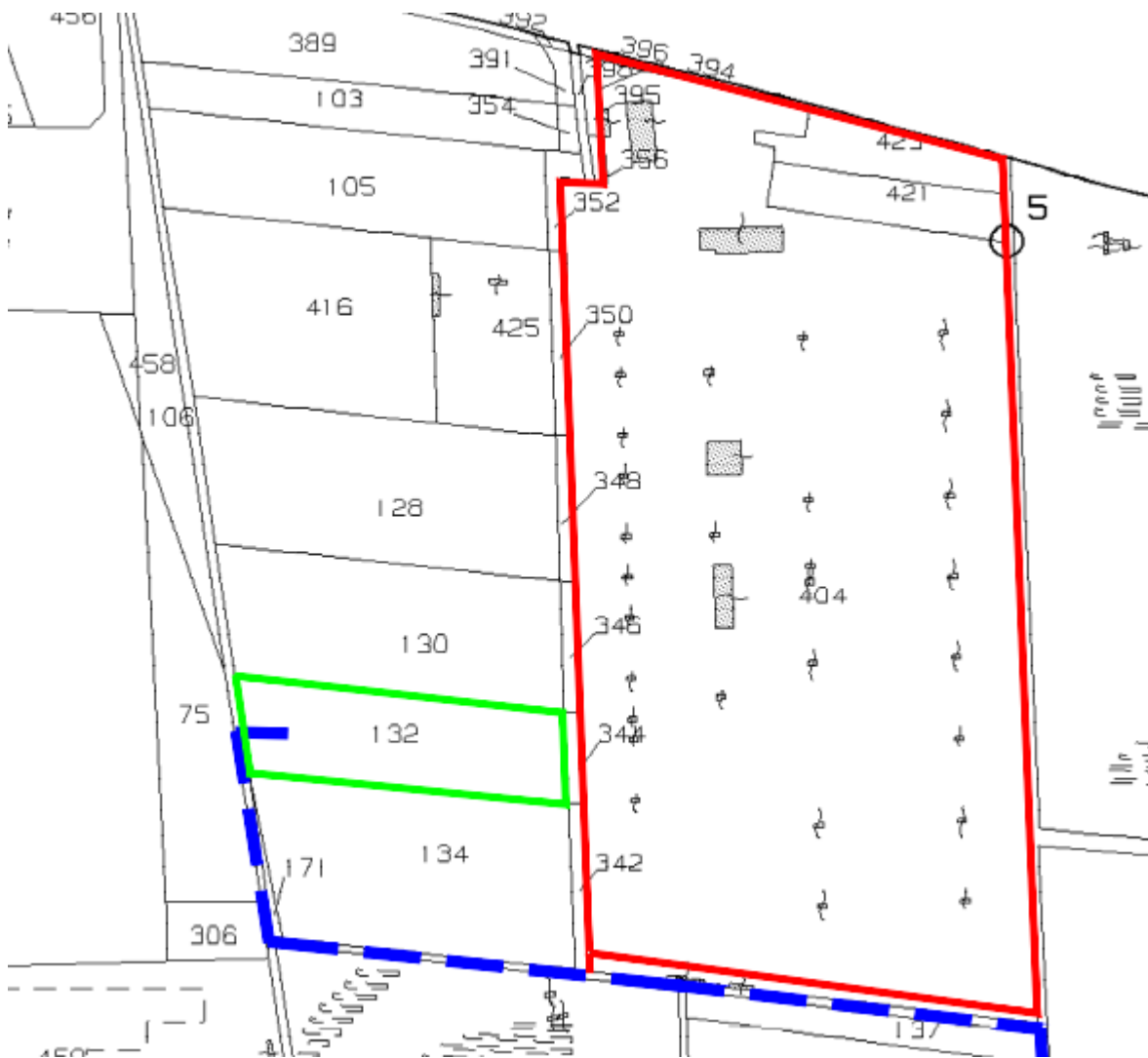
Figura: Inquadramento catastale della particella interessata dalla futura realizzazione della Stazione di elevazione (stralcio da Tavola PN_03_001). Con la linea tratteggiata in blu si indica il tracciato dell'elettrodotto. Con il rettangolo verde si indica la stazione di elevazione e con il poligono rosso viene rappresentata la stazione elettrica esistente "Brindisi Sud".
