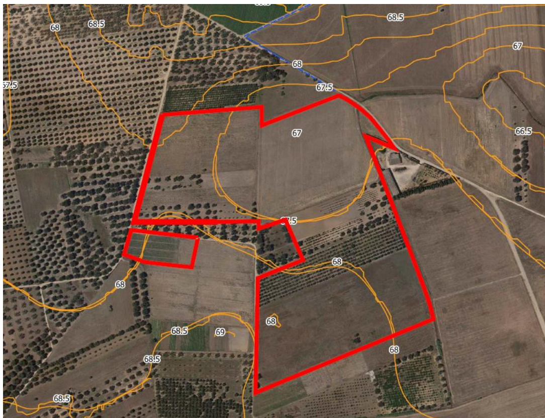
Figura: Individuazione dell'area di impianto con indicazione delle curve di livello ogni 0,5m. Tutte le quote sono riferite al livello medio mare.
