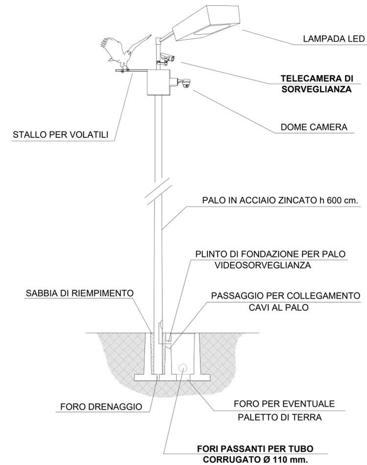
Particolare palo illuminazione e videosorveglianza - sezione A - A' da layout impianto - scala 1:50
