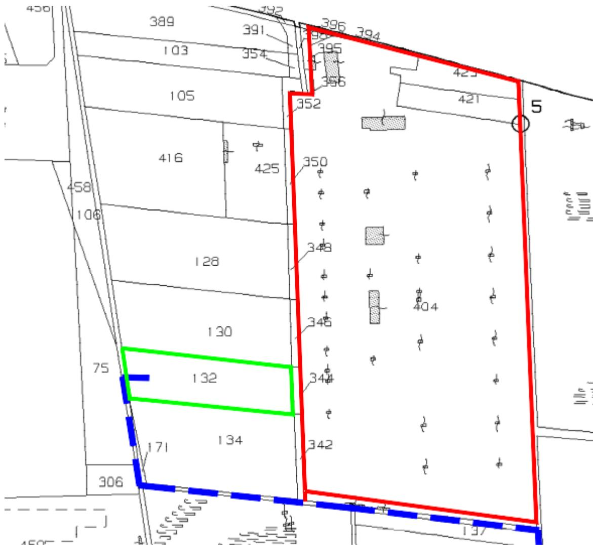
Figura: Inquadramento catastale della particella interessata dalla futura realizzazione della Stazione di elevazione (stralcio da Tavola PN\_03\_001). Con la linea tratteggiata in blu si indica il tracciato dell'elettrodotto in progetto. Con il rettangolo verde si indica l'area della stazione di elevazione in progetto e con il poligono rosso viene rappresentata la stazione elettrica esistente "Brindisi Sud".
